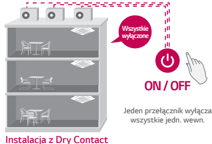
Instalacja z Dry Contact
